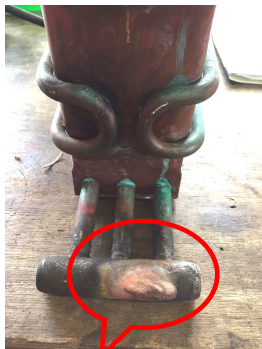
破裂箇所を溶接した後です
